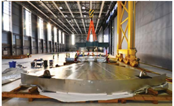
चित्र B.2.4 इटर साइट पर क्रायोस्टेट वर्कशॉप में सुपुर्द किये गये क्रायोस्टेट - आधार टायर 1 के घटक
