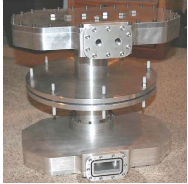
चित्र A.3.4.4 पूरी तरह से संयोजित मोड कन्वर्टर (a) S11 और S12 के मापन हेतु दोनों मोड कन्वर्टर पीछे की ओर से संयोजित रूप में (b)।
