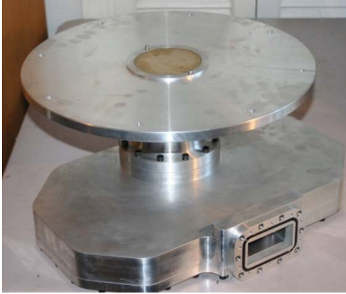
चित्र A.3.4.4 पूरी तरह से संयोजित मोड कन्वर्टर (a) S11 और S12 के मापन हेतु दोनों मोड कन्वर्टर पीछे की ओर से संयोजित रूप में (b)।
