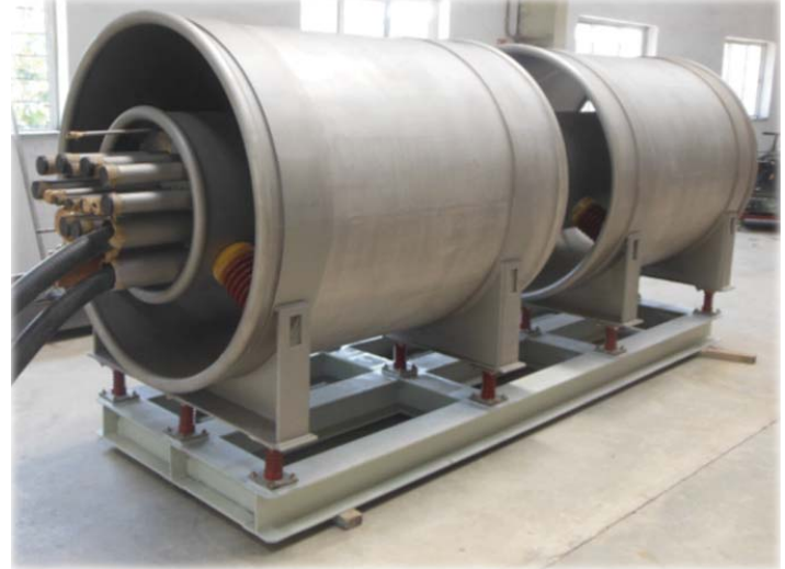
चित्र B.2.15 3.5m की उच्च वोल्टेज ट्रांसमिशन लाइन का प्रारूपी हिस्सा
