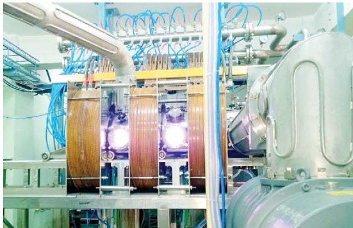
चित्र B.3.1 प्लाज़्मा सतह अंतःक्रिया के लिए सीपीपी-आईपीआर चुंबकित प्लाज़्मा प्रयोग
