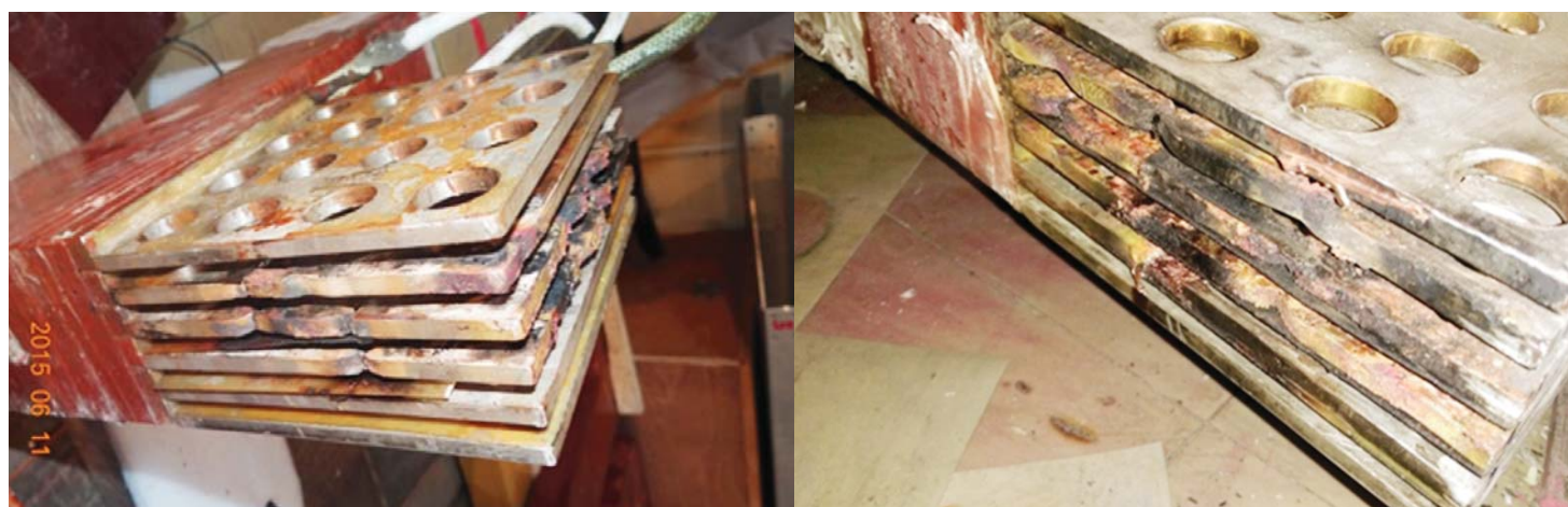
चित्र A.1.1.2. टोराइडल चुंबकीय क्षेत्र कॉयलों के क्षतिग्रस्त फिंगर जॉइंट के चित्र
