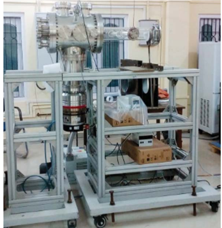
चित्र B.3.2 कांच चैम्बर, विस्तार चैम्बर, निर्वात पंपिंग प्रणाली और विभिन्न गेज के साथ HeliPS व्यवस्था
