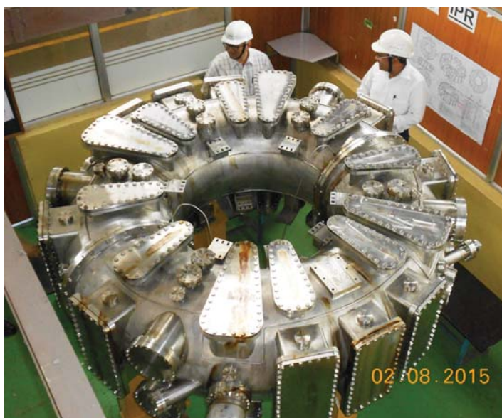
चित्र A.1.1.3. संस्थान में परीक्षण स्टैण्ड पर गोलाकार अनुप्रस्थ-काट निर्वात पात्र
