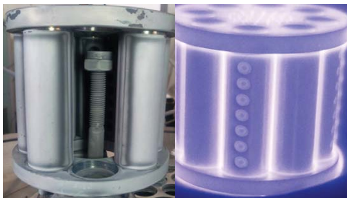
चित्र B.1.6 a) खोखली नलिकाओं से बने कैथोडी पिंजरे के मध्य में नमूना b) कैथोडी पिंजरे पर गठित प्लाज़्मा
