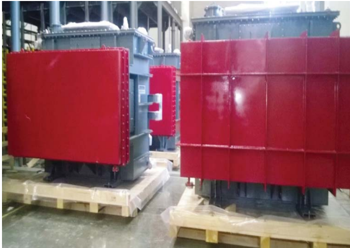
चित्र B.2.14 मेसर्स टी एण्ड आर (I) लि. अहमदाबाद द्वारा निर्मित आईईसी मानकों के 2.8MVA तेल से भरे बहुद्वितीयक ट्रांसफॉर्मर्स
