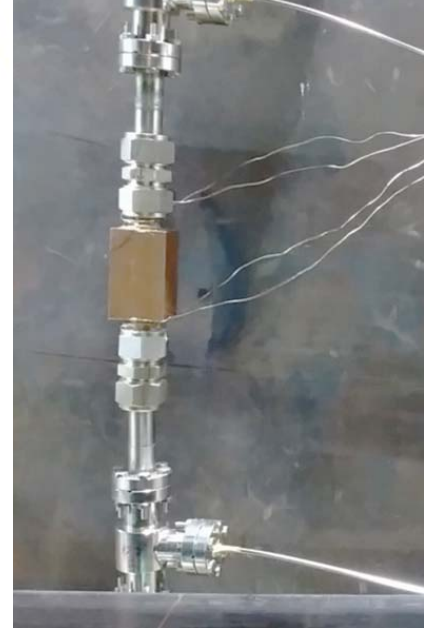
चित्र A.2.7 एचएचएफ परीक्षण संयंत्र में कैलोरीमैट्री अध्ययनों के लिए पूर्ण तांबा टेस्ट मॉक-अप, थर्मोकपल और आरटीडी का इस्तेमाल करके बनाई गई प्रयोगात्मक व्यवस्था
