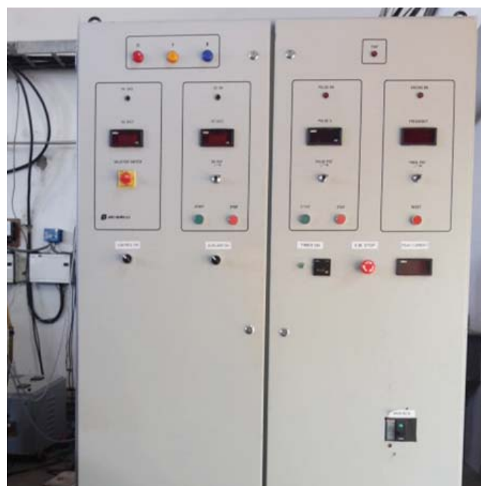
चित्र B.1.5 25KW स्पंदित शक्ति स्रोत की छवि
