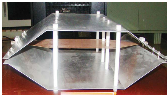
चित्र A.3.4.2 उच्च आवृत्ति नैदानिकी के अंशांकन हेतु विकसित टीईएम सेल
